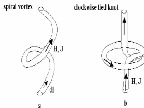
Fig. 3. a) Spiral vortex in superconductor
